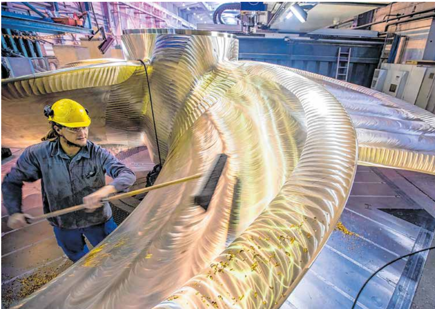
Heute Weltmarktführer in einem Spezialgebiet: Die Mecklenburger Metallguss GmbH (MMG) in Waren baut Propeller für Container- und Kreuzfahrtschiffe. Auf hundertstel Millimeter genau werden die tonnenschweren Schiffsantriebe gefräst und geschliffen. Foto: dpa/Jens Büttner
